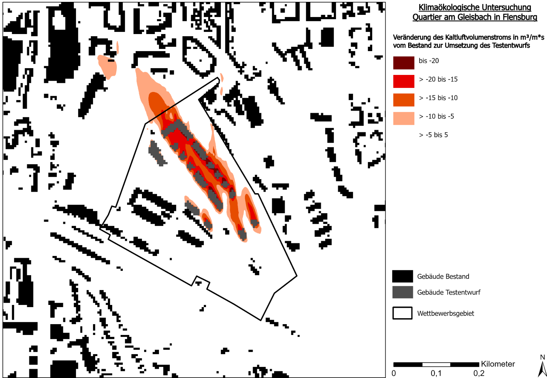
Abb. 14: Abweichung des Kaltluftvolumenstroms in m^3/s*m vom Entwurf zum Bestand um 4 Uhr morgens.
