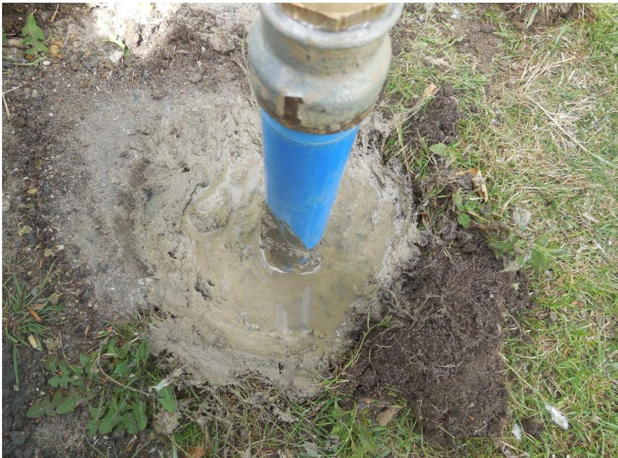
**Bild 1:** Abgedichteter Messpegel zur Bodenluftuntersuchung (Beispiel: KB12)
