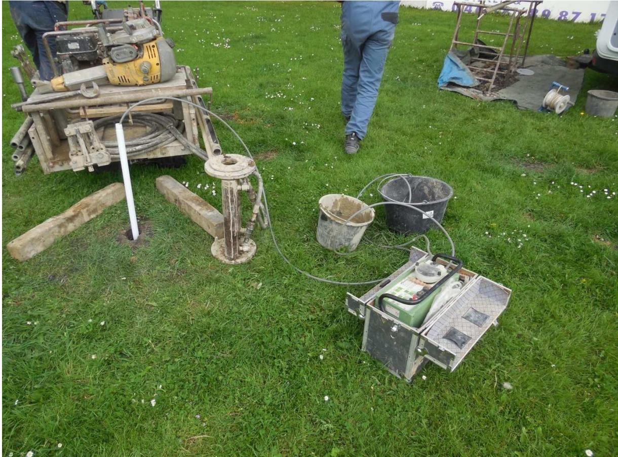
**Bild 2:** Wasserprobenahme aus temporärem Pegel (Beispiel: B2)
